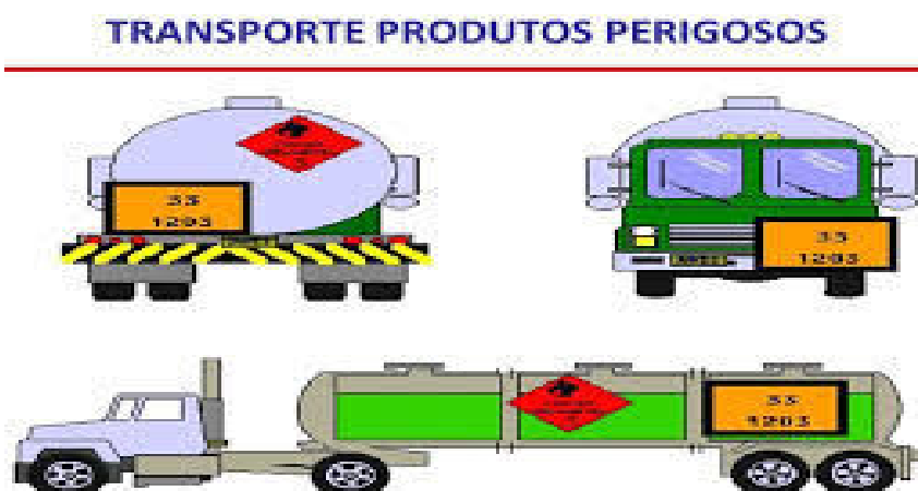
Figura 11: Painel de segurança cor laranja instalado em caminhões (extraído Manual CNTT 01/2013 p.52).
